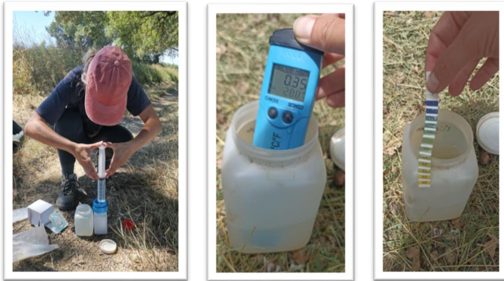
Figure 5 (à gauche) : Photographie du filtrage d'un échantillon d'eau de mare sur place.
